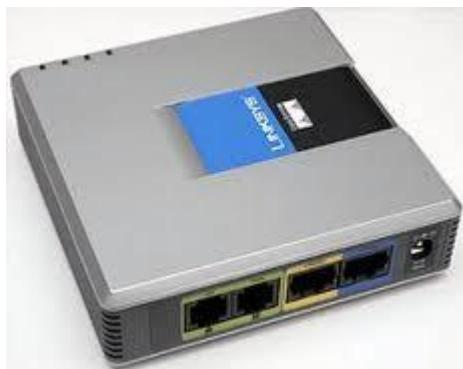
FXO - Foreign eXchange Office. É a interface que recebe a linha analógica. É o plug no telefone ou aparelho de fax, ou o(s) plug(s) no seu sistema de telefonia analógica. Indica se o telefone está no gancho/fora do gancho (círcuito fechado). Como a porta FXO está ligada a um dispositivo, tal como fax ou telefone, esse dispositivo é normalmente chamado de „dispositivo FXO“.
